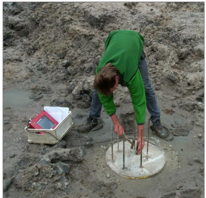
Fig. 1 | Doormeten van de palen voor koppensnellen
